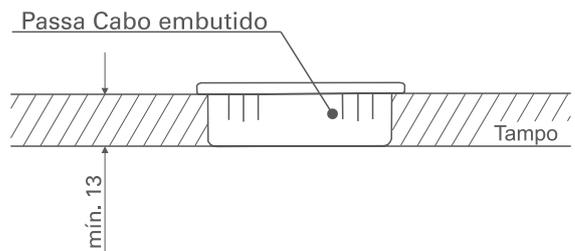
Orifício dotados de cerdas para a passagem dos cabos
