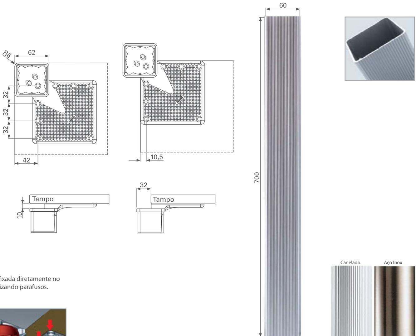
A flange é fixada diretamente no tampo, utilizando parafusos.
